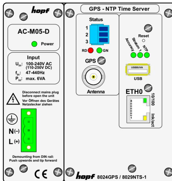
Trotz seines **breiten Funktionsspektrums** ist der Time Server 8029NTS/GPS in einem kompakten Hutschienengehäuse integriert und zeichnet sich durch seine einfache und übersichtliche Bedienung aus. Einige der praxisorientierten Funktionalitäten sind z.B.:
