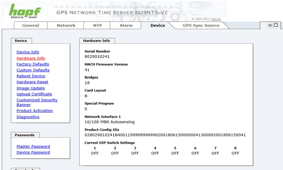
Die Anzeige "Current DIP Switch Settings" ist bei diesem Gerät ohne Funktion.
