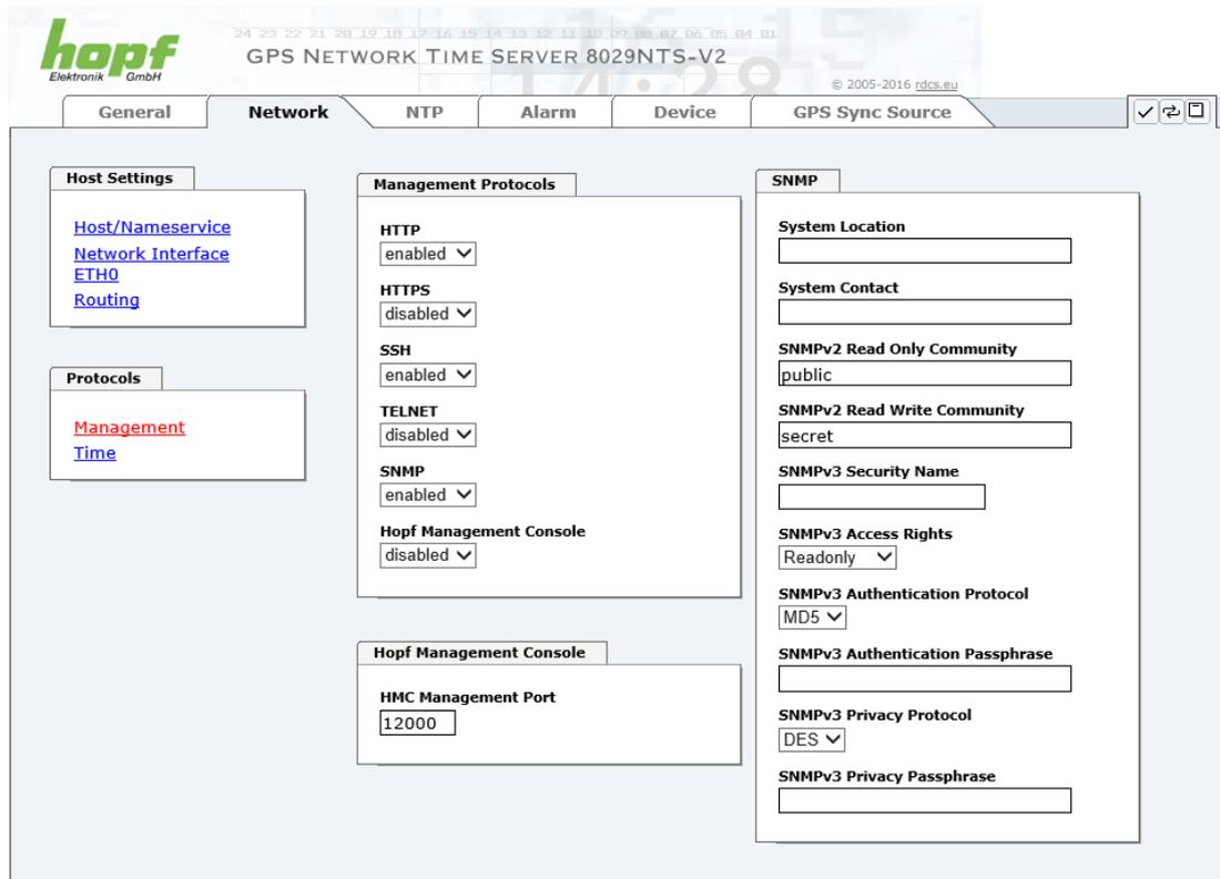
Bei Verwendung von SNMP und SNMP-Traps ist hier das Protokoll SNMP zu aktivieren (enabled).
