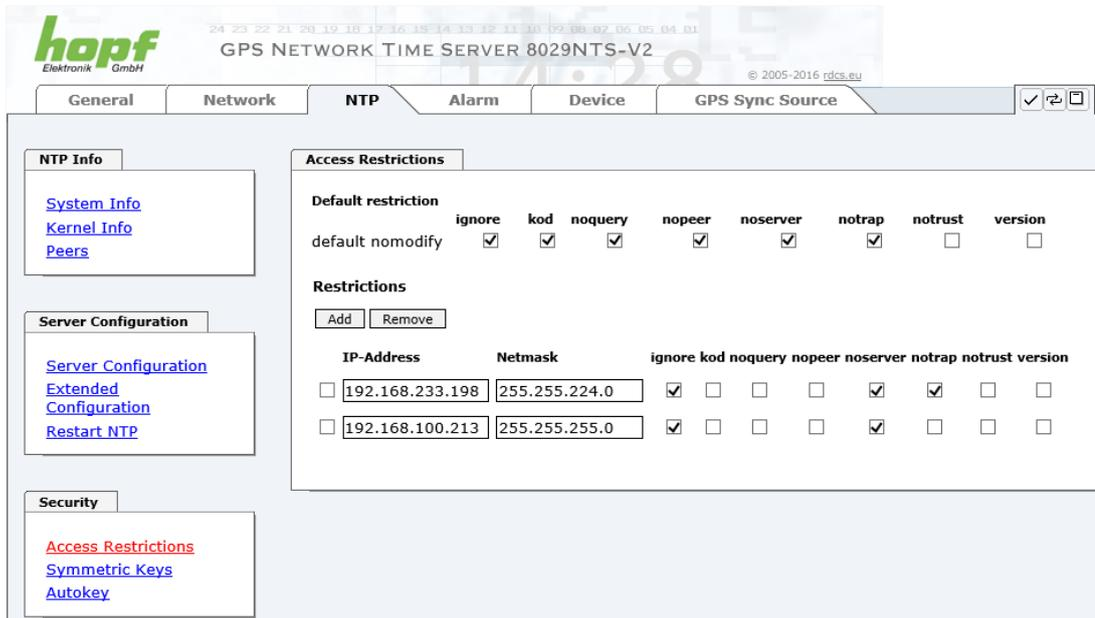
Beschränkungen werden verwendet, um den Zugriff auf den NTP-Service des Systems zu kontrollieren und sind bedauerlicherweise die meist missverstandenen Optionen der NTP Konfiguration.
