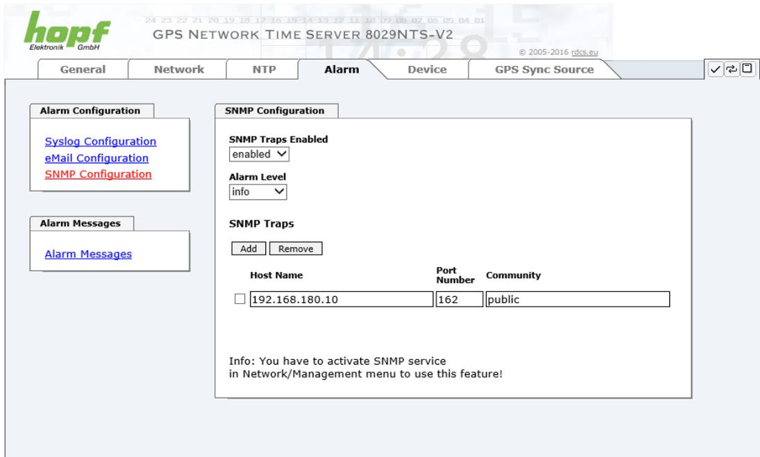
SNMP Traps werden über das Netzwerk zu den konfigurierten Hosts gesendet. Man beachte, dass sie auf UDP basieren, daher ist es nicht garantiert, dass sie den konfigurierten Host erreichen!
