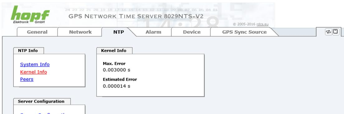
Dieser Screenshot zeigt einen maximalen Fehler der Kernel-Uhr von 3,000 msec (Millisekunden) an, der geschätzte Fehlerwert liegt bei 14 µs (Mikrosekunden).
