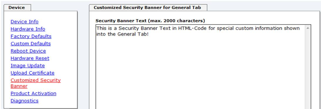
Die Sicherheitsinformation kann als 'unformatierter' Text aber auch im HTML-Format beschrieben werden. Hierfür stehen 2000 Zeichen zur Verfügung, die ausfallsicher in dem Time Server 8029NTS/GPS gespeichert werden.
