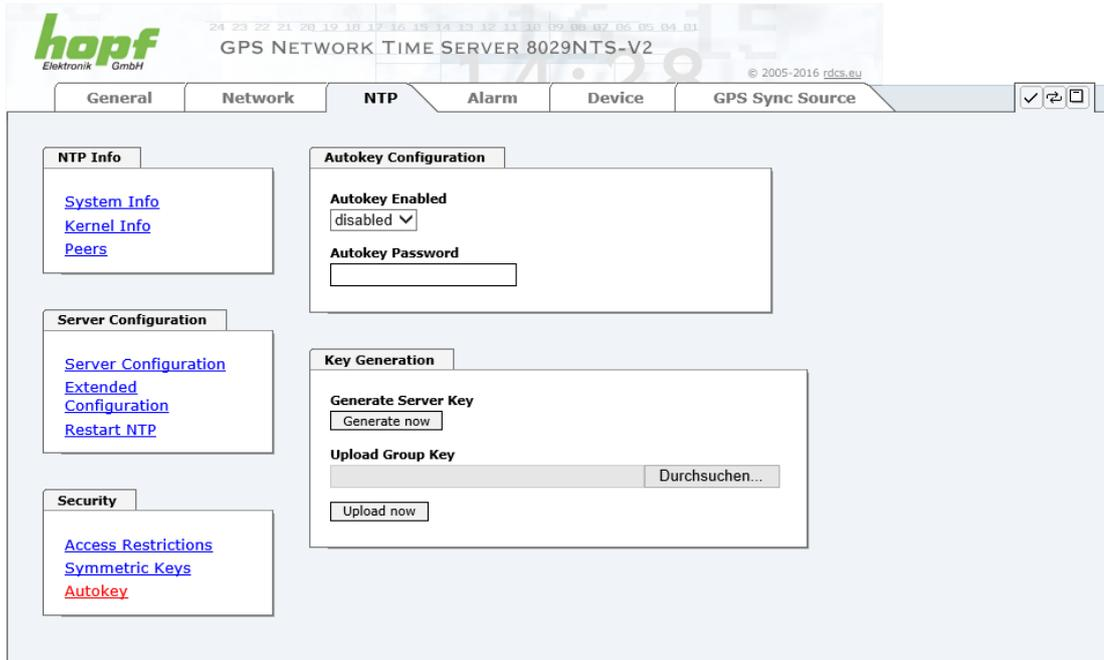
Um die Autokey v2 Authentifizierung zu aktivieren, muss die Autokey Enabled Option auf "enabled" gestellt werden und ein Passwort spezifiziert werden (darf nicht leer sein).
