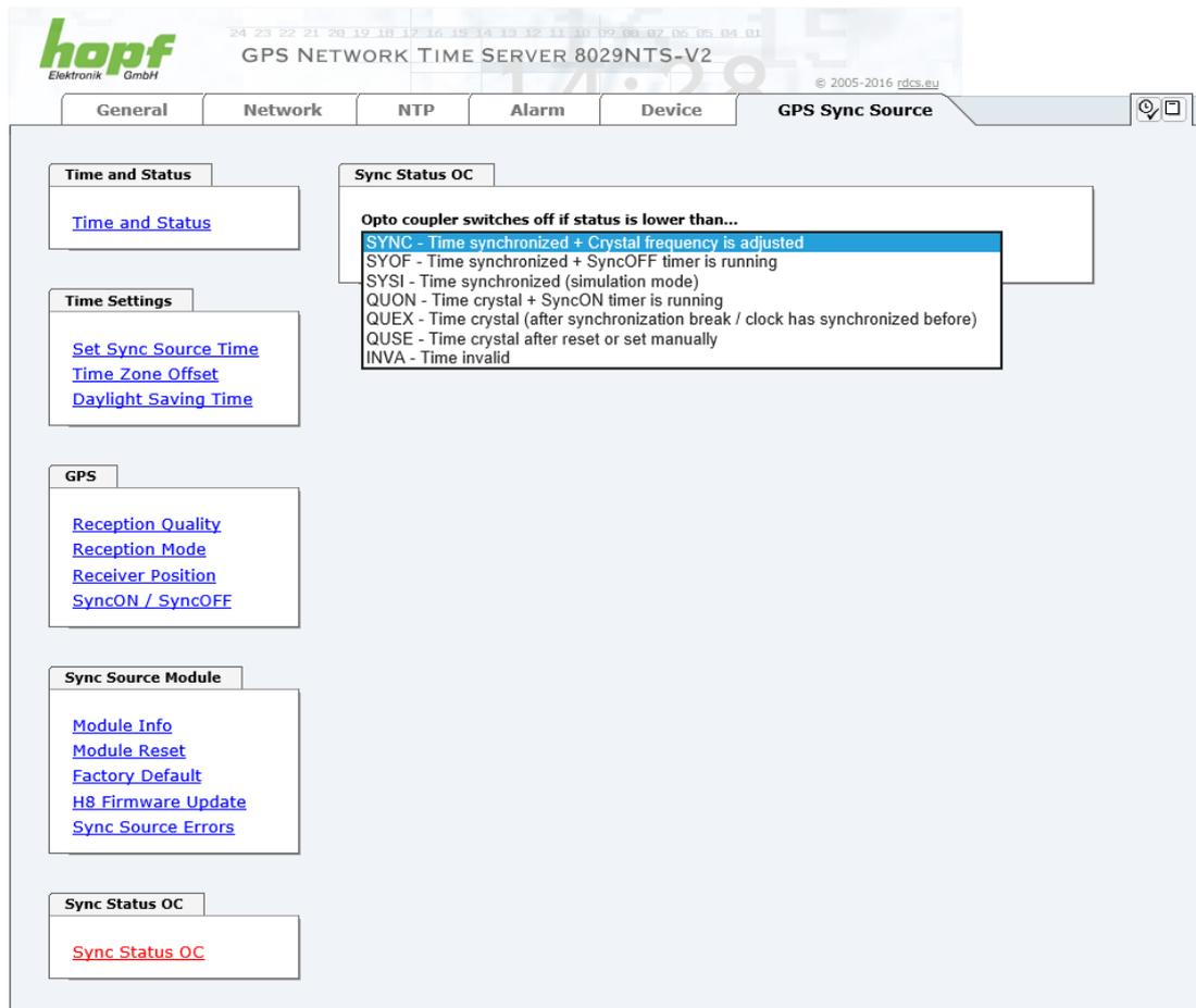
Mit dieser Funktion kann die Ausgabe des Status-Optokopplers (auf der Frontblende des Time Server 8029NTS/GPS) konfiguriert werden.
