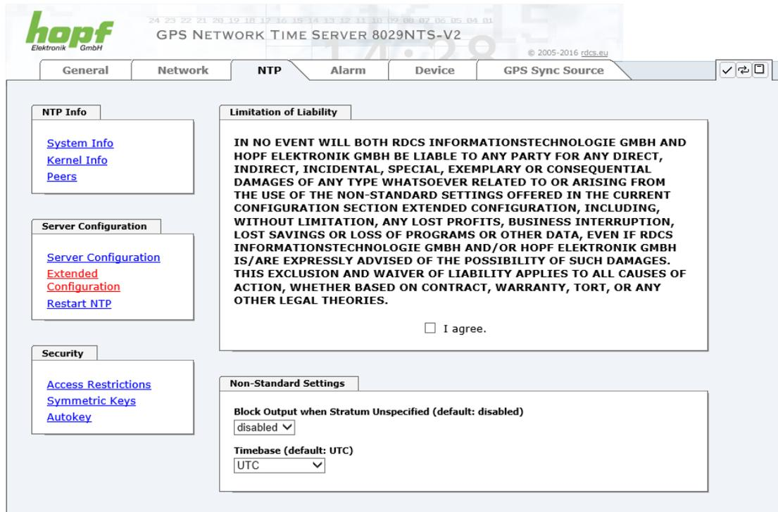
Damit diese spezielle NTP-Einstellung aktiviert werden kann, muss die im WebGUI dargestellte Einverständniserklärung bestätigt werden, in dem das "I agree"-Feld abgehakt wird.
