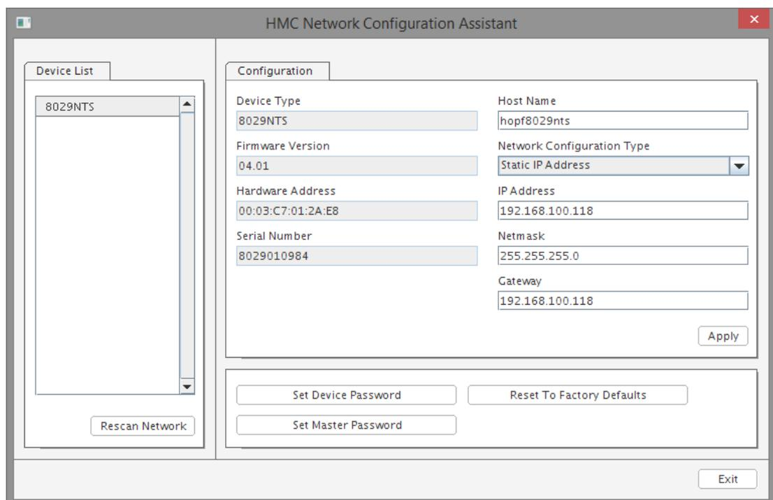
Zur erweiterten Konfiguration des Time Server 8029NTS/GPS über einen Web Browser via WebGUI sind folgende Basis LAN-Parameter erforderlich:
