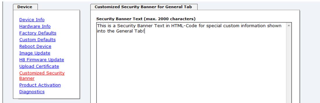
Die Sicherheitsinformation kann als 'unformatierter' Text aber auch im HTML-Format beschrieben werden. Hierfür stehen 2000 Zeichen zur Verfügung, die ausfallsicher in dem Time Server 8029NTS/M gespeichert werden.
