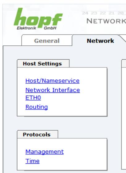
Innerhalb der Registerkarten führt jeder Link der Navigation auf der linken Seite zu zugehörigen detaillierten Anzeige oder Einstellmöglichkeit.
