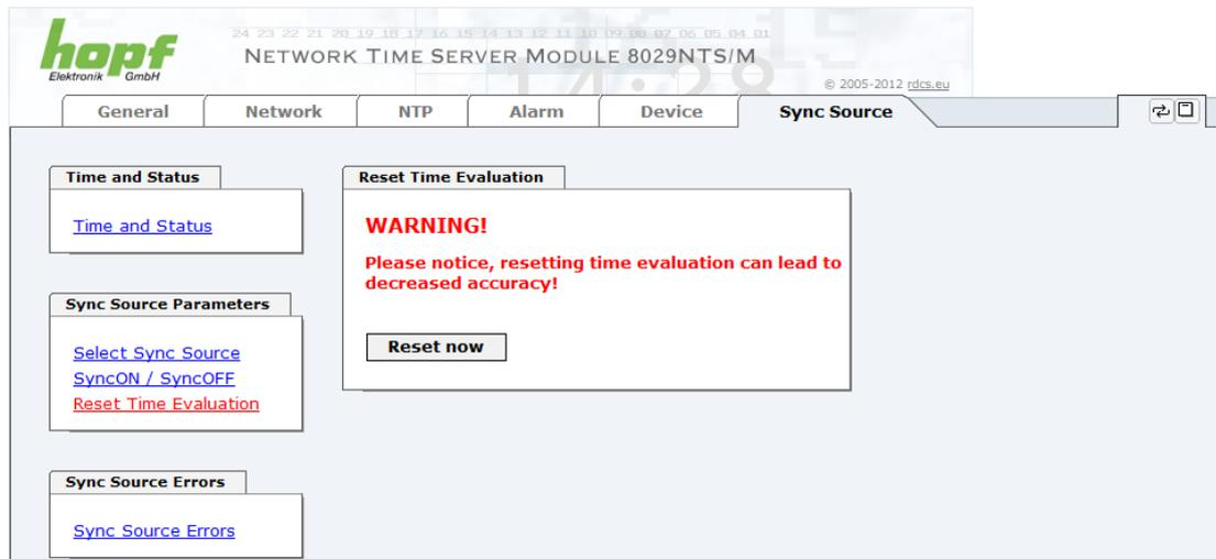
Mit der Funktion "Reset Time Evaluation" kann die gesamte interne Auswertung der dem Modul zugeführten Zeitinformation inkl. eventuell anliegender Ankündigungen für SZ-WZ Umschaltung bzw. einfügen einer Schaltsekunde zurückgesetzt werden.
