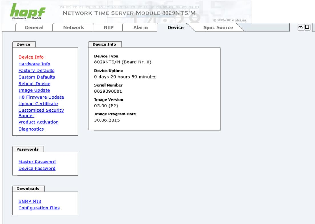
Diese Registerkarte stellt die grundlegende Information über die Hardware des Moduls 8029NTS/M wie auch Software/Firmware zur Verfügung. Die Passwort Verwaltung sowie die Update Services für das Modul werden ebenfalls über diese Webseite zugänglich gemacht. Der komplette Downloadbereich ist auch ein Bestandteil dieser Seite.
