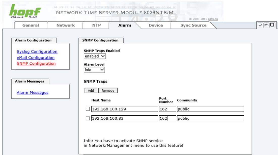
SNMP Traps werden über das Netzwerk zu den konfigurierten Hosts gesendet. Man beachte, dass sie auf UDP basieren, daher ist es nicht garantiert, dass sie den konfigurierten Host erreichen!
