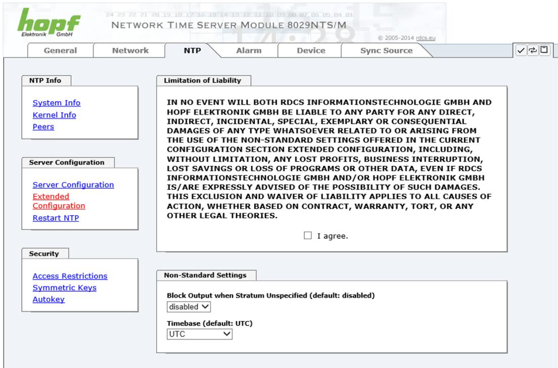
Damit diese spezielle NTP-Ausgabe aktiviert werden kann muss die im WebGUI dargestellte Einverständniserklärung bestätigt werden, in dem das "I agree"-Feld abgehakt wird.
