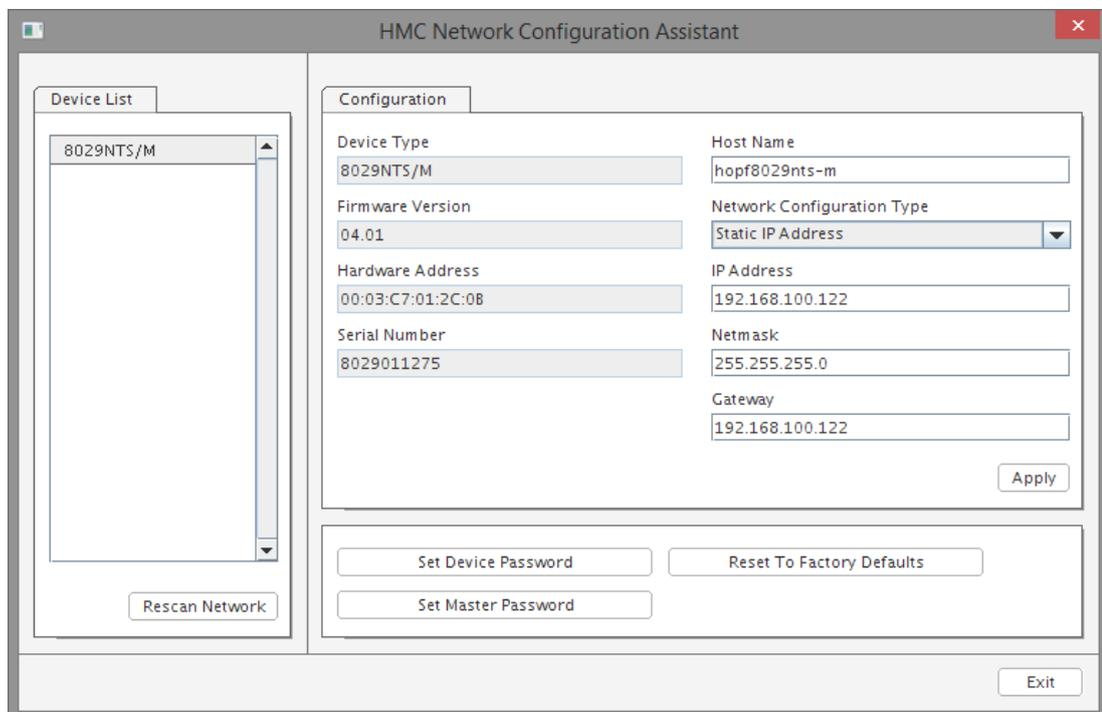
Zur erweiterten Konfiguration des Time Server 8029NTS/M über einen Web Browser via Web-GUI sind folgende Basis LAN-Parameter erforderlich:
