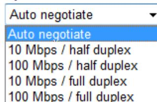
Normalerweise gleicht das Netzwerkgerät den Datenfluss und den Duplex Modus automatisch an das Gerät an, mit dem es verbunden wird (z.B. HUB, SWITCH). Muss das Netzwerkgerät eine bestimmte Geschwindigkeit oder einen bestimmten Duplex Modus haben, so kann dies über die Web Oberfläche konfiguriert werden. Der Wert sollte nur in speziellen Fällen verändert werden. Im Normalfall wird die automatische Einstellung verwendet.
