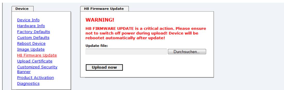
Nach dem H8-Firmwarupdate erfolgt automatisch ein Restart der Karte mit der neuen H8-Firmware.
