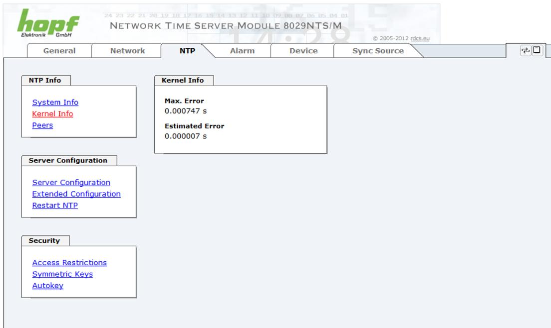
Dieser Screenshot zeigt einen maximalen Fehler der Kernel-Uhr von 0,747 msec (Millisekunden) an, der geschätzte Fehlerwert liegt bei 7 µs (Mikrosekunden).
