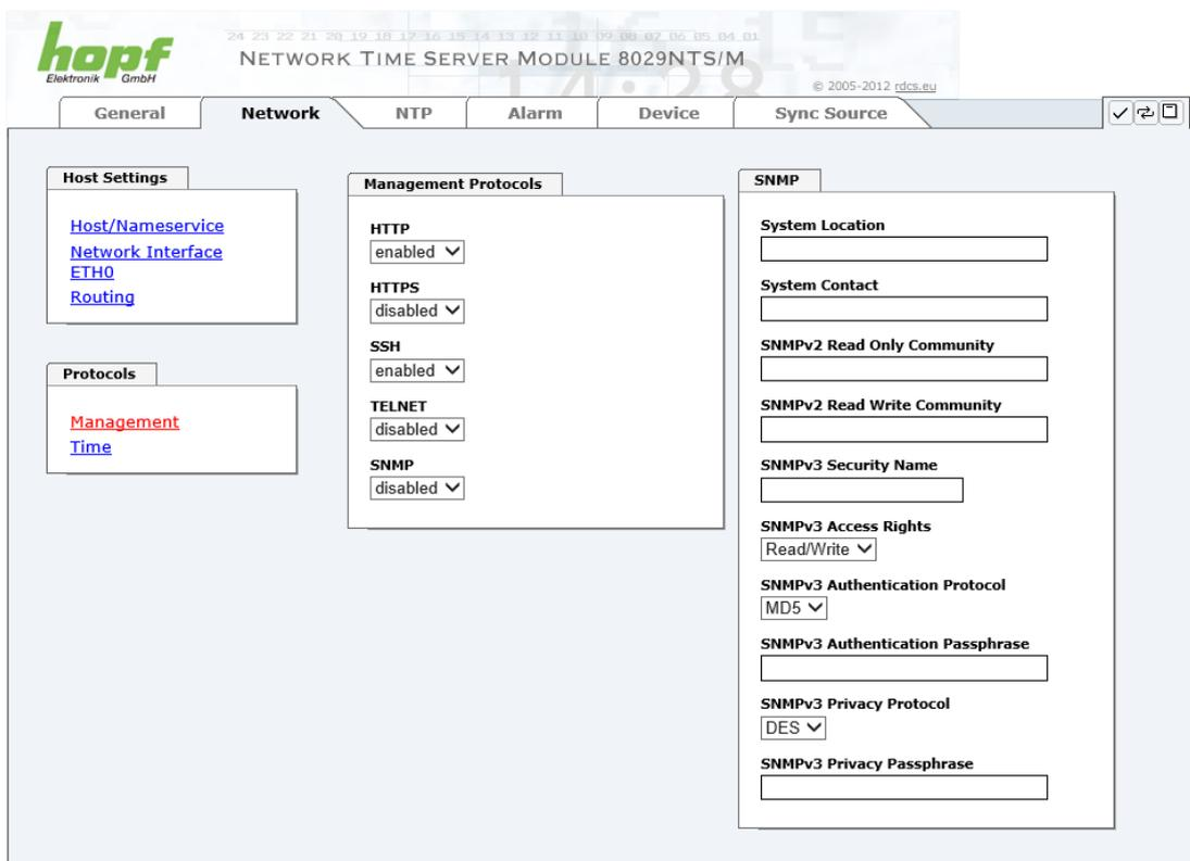
Nach einer Eingabe mit **Apply** wird das konfigurierte Feld mit einem Stern ' \* ' markiert, das bedeutet, dass ein Wert verändert oder eingetragen wurde, dieser aber noch nicht im Flash gespeichert ist.
