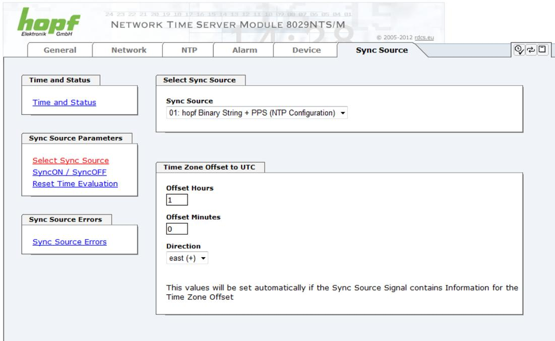
Das Modul 8029NTS/M kann mit verschiedenen Zeitinformationen synchronisiert werden. Die jeweils erforderliche Einstellung wird beim Einsatz dieser Module in **hopf** Basis-Systemen bereits werkseitig durchgeführt.
