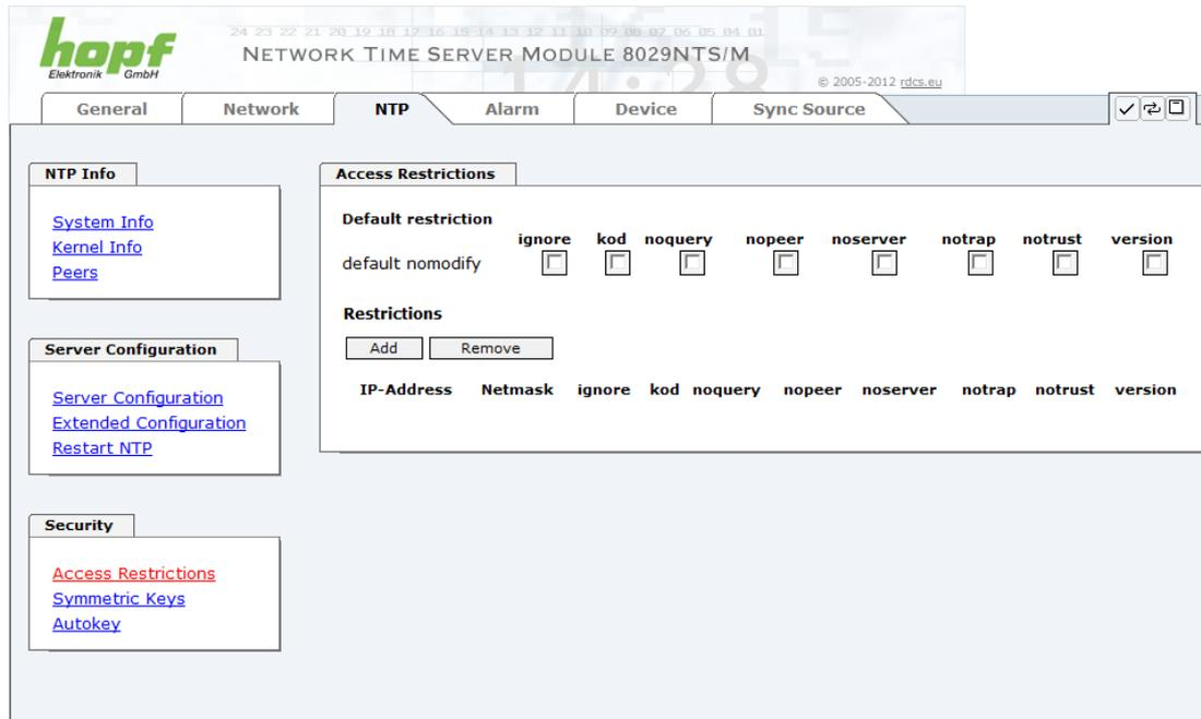
Beschränkungen werden verwendet, um den Zugriff auf den NTP-Service des Systems zu kontrollieren und sind bedauerlicherweise die meist missverstandenen Optionen der NTP Konfiguration.
