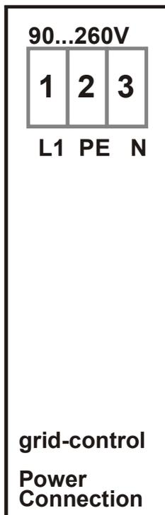
Die zu analysierende Netzfrequenz wird über eine 3-polige Schraubklemme für 4mm<sup>2</sup> Leitungen eingespeist.
