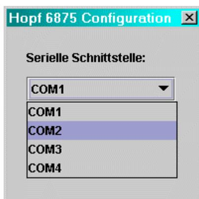
Nach Auswahl der entsprechenden Schnittstelle versucht die Hopf 6875 Konfigurationssoftware, Verbindung mit der Funkuhr aufzunehmen. Wenn keine Verbindung hergestellt werden kann, wird eine entsprechende Meldung ausgegeben. In diesem Fall prüfen Sie bitte, ob die Verkabelung korrekt ist bzw. das Kabel an die richtigen Schnittstellen angeschlossen ist.
