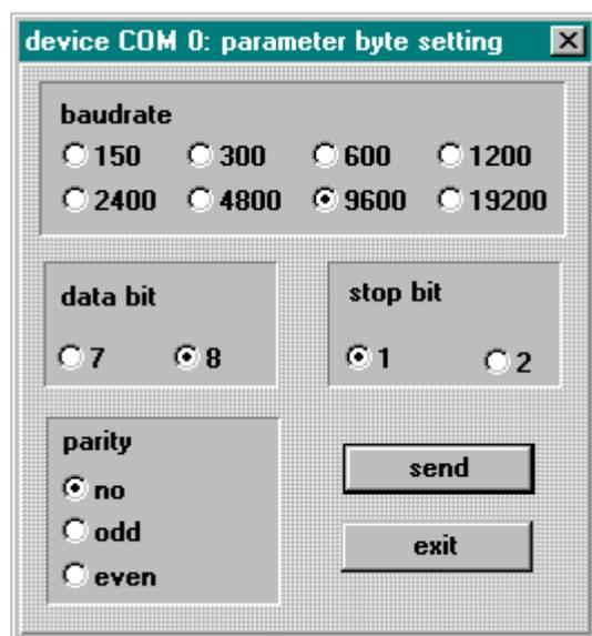
Sie erreichen die Einstellung für Baudrate, Datenbit, Stoppbit und Parity durch Anwahl des Menü "**communication**" und "**serial parameter**". Es erscheint der Schnittstellenparameter-Dialog für die ausgewählte Schnittstelle.
