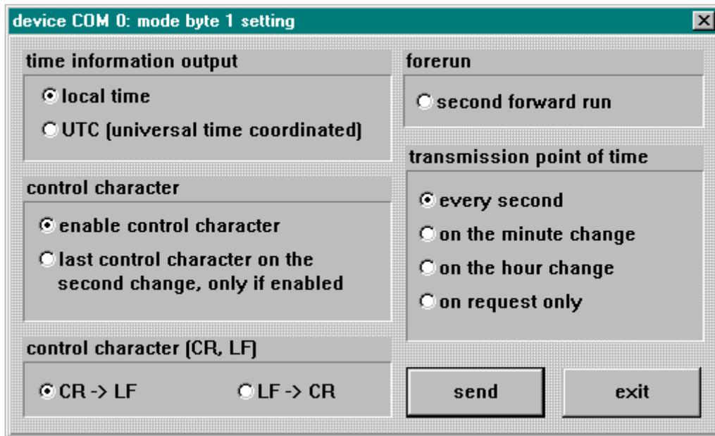
Sie erreichen die Setz-Funktion für das **Modebyte 1** durch Anwahl des Menü "**communication**" und "**mode byte 1**". Es erscheint der Modebyte 1 Dialog mit den aktuellen Einstellungen für die ausgewählte Schnittstelle. Sie können jetzt den Ausgabemechanismus nach Ihren Vorgaben konfigurieren. Sie starten die Übertragung zur Uhr mit dem "**send**" Schalter. Wenn die Daten angenommen wurden erscheint ein Dialogfenster mit dem Hinweis:
