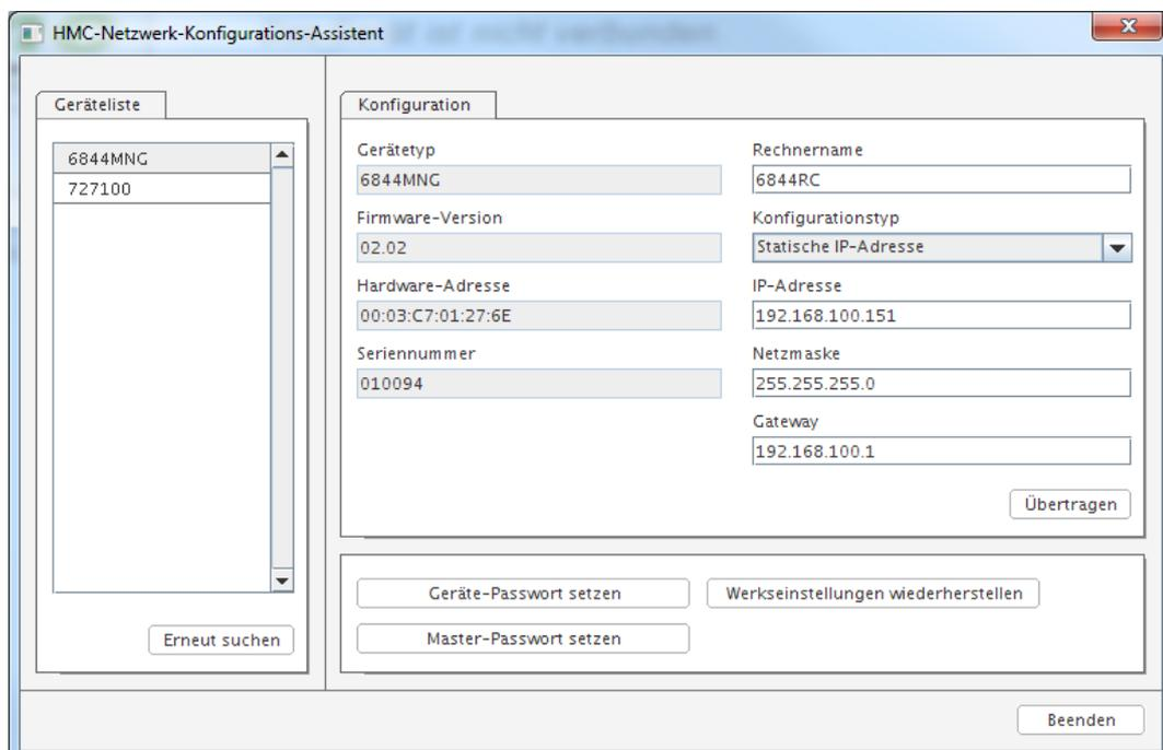
Zur erweiterten Konfiguration (WebGUI) des LAN-Moduls 6844MNG über einen Browser sind folgende Basis LAN-Parameter erforderlich:
