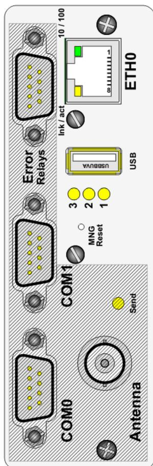
**ETH0-RJ45 Buchse** - Ethernet LAN-Schnittstelle
