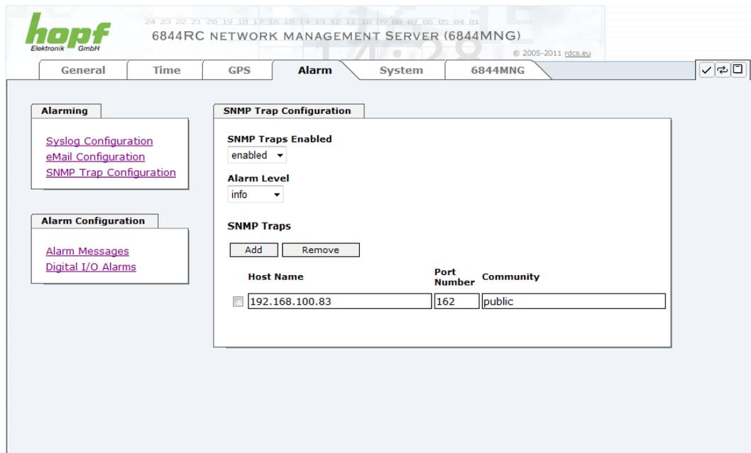
SNMP Traps werden über das Netzwerk zu den konfigurierten Hosts gesendet. Man beachte, dass sie auf UDP basieren, daher ist es nicht garantiert, dass sie den konfigurierten Host erreichen! Es können mehrere Hosts konfiguriert werden, allerdings haben alle den selben Alarm-Level.
