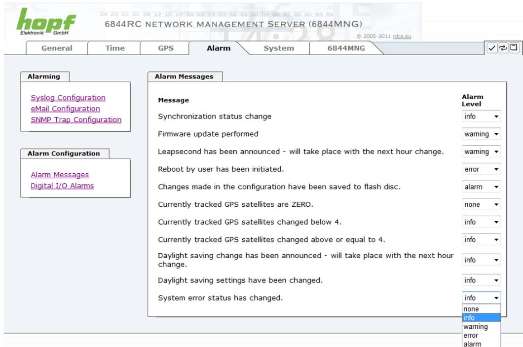
Abhängig von den Nachrichten, ihrer konfigurierten Levels und der konfigurierten Notification Levels der E-mails, wird im Falle eines Ereignisses eine entsprechende Aktion durchgeführt.
