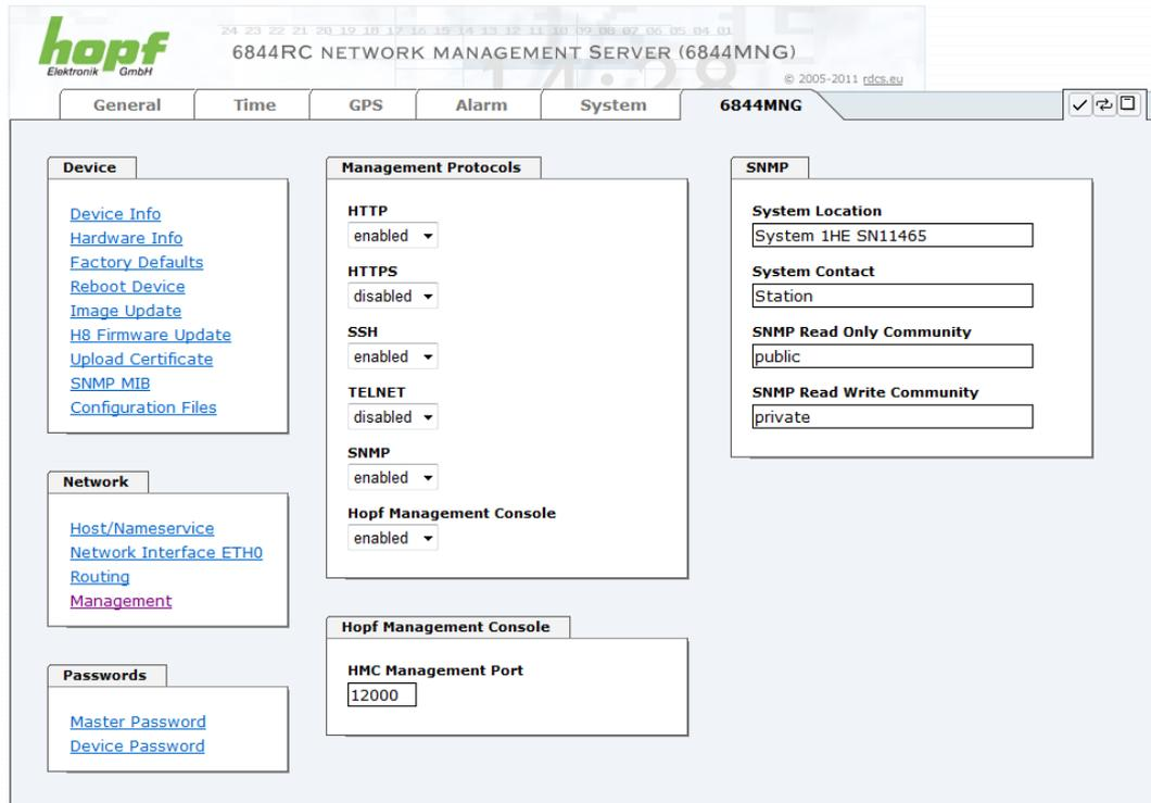
Für die korrekte Operation des SNMP müssen alle Felder ausgefüllt sein. Sind nicht alle Werte bekannt, muss der Netzwerkadministrator herangezogen werden.
