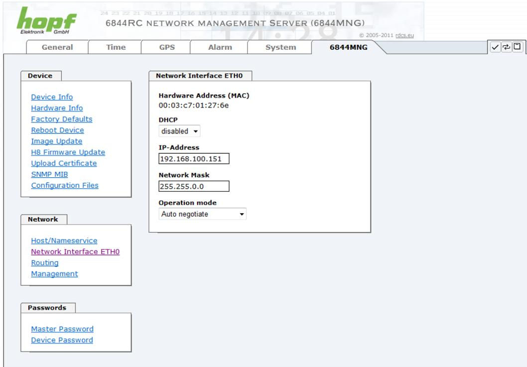
Nach einer Eingabe wird das konfigurierte Feld mit einem Stern ' \* ' markiert, das bedeutet dass ein Wert verändert oder eingetragen wurde, dieser aber noch nicht im Flash gespeichert ist. Um die Konfiguration oder den veränderten Wert dauerhaft zu speichern, ist es notwendig, die Bedeutung der unten stehenden Symbole zu kennen.
