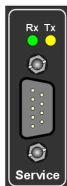
Die Service-Schnittstelle (9-poliger SUB-D Stecker) dient für Updates und andere gerätespezifische Funktionen. Diese Schnittstelle wird nicht für den normalen Betrieb des Displays benötigt. Die Schnittstelle ist nur nach Rücksprache mit Fa. **hopf** im Supportfall zu verwenden. In diesem Fall wird eine spezielle Benutzerinformation und die erforderliche Software durch die Fa. **hopf** bereitgestellt.
