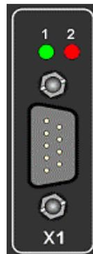
Über den 9-poligen SUB-D Stecker X1 kann das Display mit einem DCF77-Takt (1Hz) im TTL und RS422 Pegel synchronisiert werden. Des weiteren steht über diesen Stecker eine abgesicherte 5Volt Versorgungsspannung für externe Taktgeber bzw. externe DCF77 Empfänger zur Verfügung.
