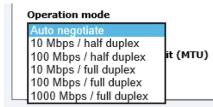
Normalerweise gleicht das Netzwerkgerät den Datenfluss und den Duplex Modus automatisch an das Gerät an, mit dem es verbunden wird (z.B. HUB, SWITCH). Muss das Netzwerkgerät eine bestimmte Geschwindigkeit oder einen bestimmten Duplex Modus haben, so kann dies über die Web-Oberfläche konfiguriert werden. Der Wert sollte nur in speziellen Fällen verändert werden. Im Normalfall wird die automatische Einstellung verwendet.
