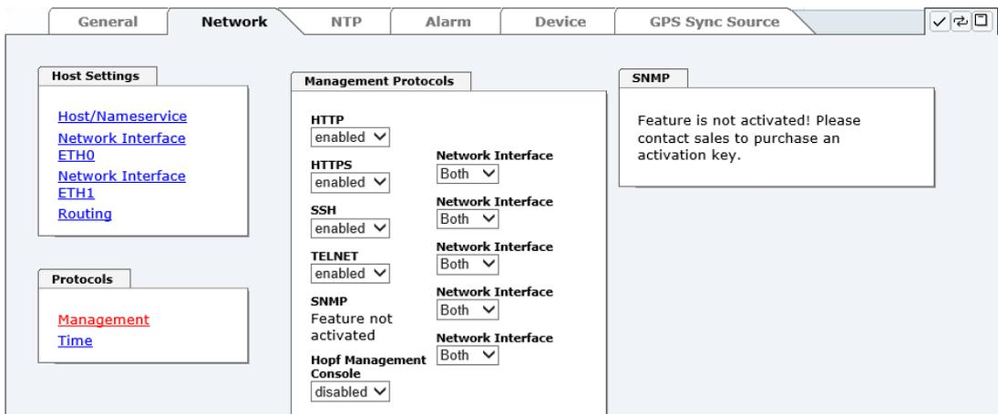
Nach einer Eingabe mit **Apply** wird das konfigurierte Feld mit einem Stern ' \* ' markiert, das bedeutet, dass ein Wert verändert oder eingetragen wurde, dieser aber noch nicht im Flash gespeichert ist.
