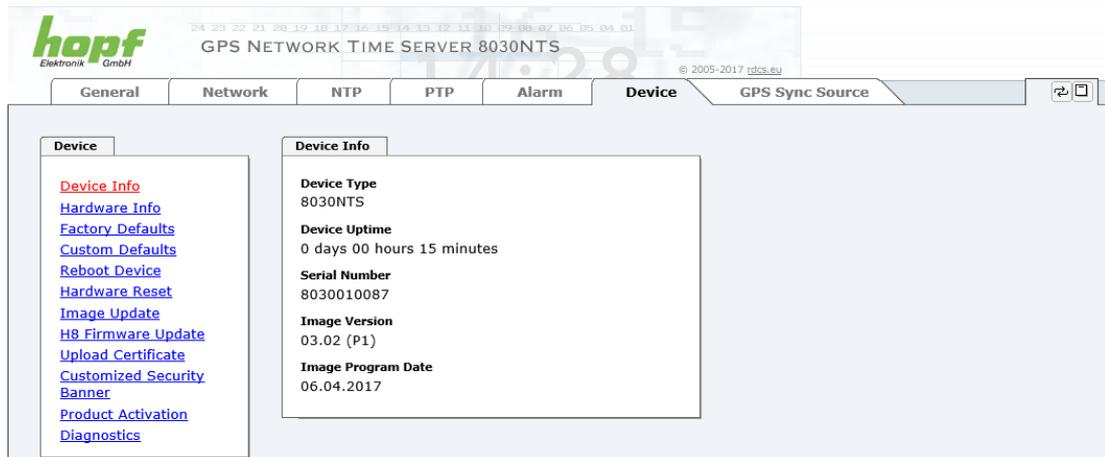
Diese Registerkarte stellt die grundlegende Information über die Hardware des Moduls 8030NTS wie auch Software/Firmware zur Verfügung. Die Passwort Verwaltung sowie die Update Services für das Modul werden ebenfalls über diese Webseite zugänglich gemacht. Der komplette Downloadbereich ist auch ein Bestandteil dieser Seite.
