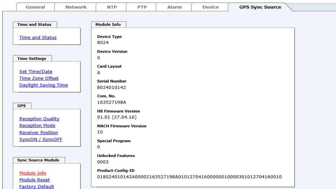
Dieses Register gibt Informationen über Hardware und Software des im Time Server 8030NTS/GPS integrierten Moduls 8024GPS (Sync Source) wieder.
