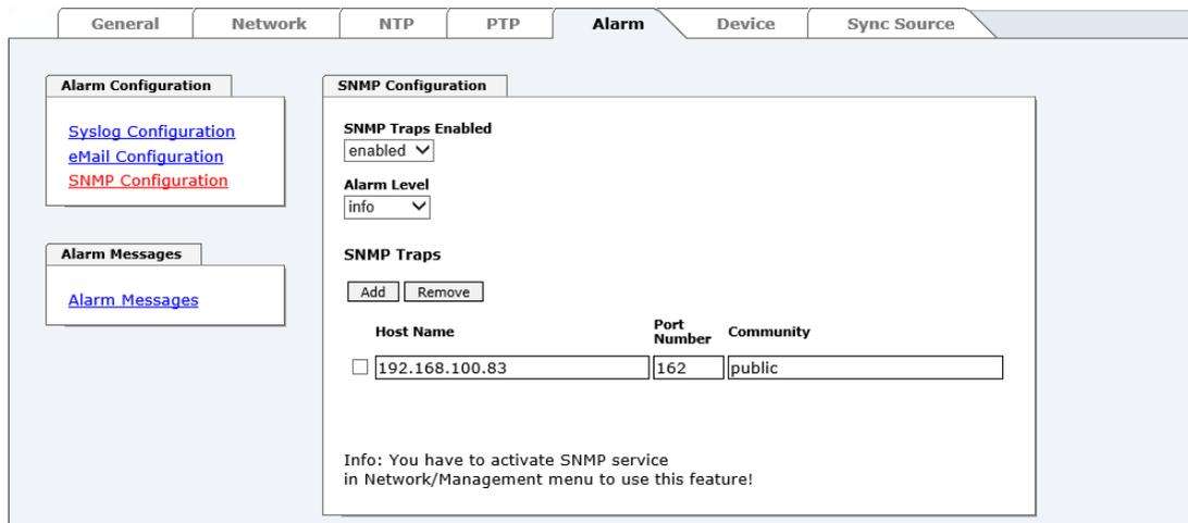
SNMP Traps werden über das Netzwerk zu den konfigurierten Hosts gesendet. Man beachte, dass sie auf UDP basieren, daher ist es nicht garantiert, dass sie den konfigurierten Host erreichen!
