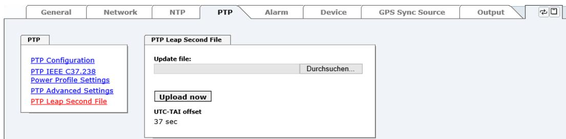
Wenn durch die Synchronisations-Quelle eine Schaltsekunde angekündigt wird, wird die Leap-Second-Datei automatisch aktualisiert.
