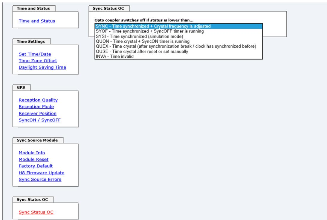
Mit dieser Funktion kann die Ausgabe des Status-Optokopplers (auf der Frontblende des Time Server 8030NTS/GPS) konfiguriert werden.
