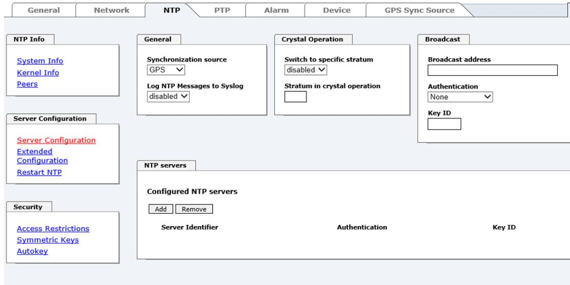
Standardmäßig ist der **hopf - refclock ntp driver** bereits konfiguriert (127.127.38.0 in der Peers Übersicht) und wird hier nicht explizit angezeigt.
