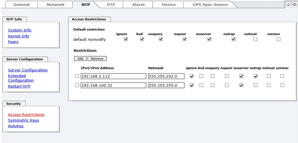
Beschränkungen werden verwendet, um den Zugriff auf den NTP-Service des Systems zu kontrollieren und sind bedauerlicherweise die meist missverstandenen Optionen der NTP Konfiguration.
