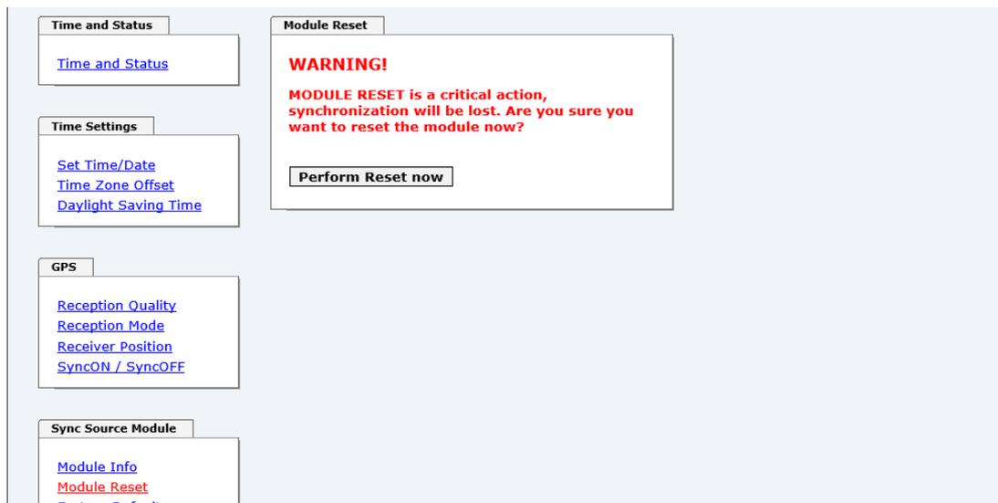
Mit dieser Funktion wird ein Hardware Reset (nur) der Sync Source (hier Modul 8024GPS) ausgelöst.
