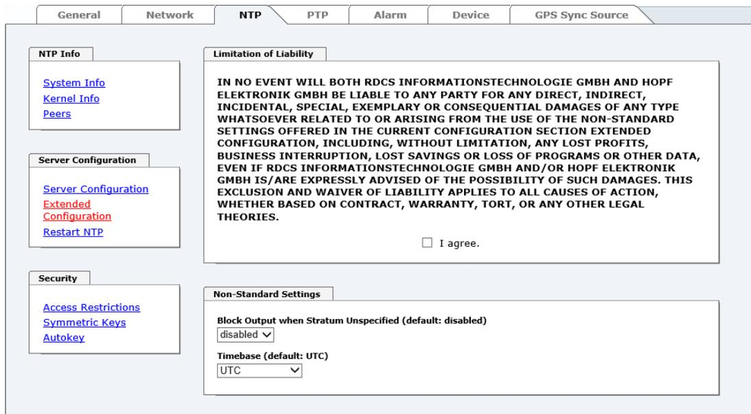
Damit diese spezielle NTP-Einstellung aktiviert werden kann, muss die im WebGUI dargestellte Einverständniserklärung bestätigt werden, in dem das "I agree"-Feld abgehakt wird.
