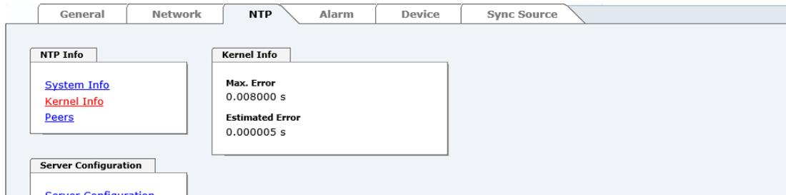
Dieser Screenshot zeigt einen maximalen Fehler der Kernel-Uhr von 8,000 msec (Millisekunden) an, der geschätzte Fehlerwert liegt bei 5 µs (Mikrosekunden).
