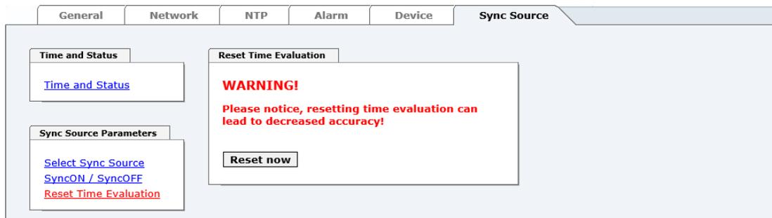
Mit der Funktion "Reset Time Evaluation" kann die gesamte interne Auswertung der dem Modul zugeführten Zeitinformation inkl. eventuell anliegender Ankündigungen für SZ-WZ Umschaltung bzw. einfügen einer Schaltsekunde zurückgesetzt werden.
