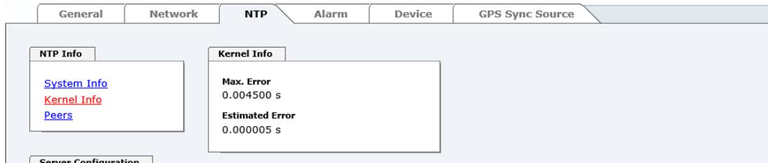
Dieser Screenshot zeigt einen maximalen Fehler der Kernel-Uhr von 4,500 msec (Millisekunden) an, der geschätzte Fehlerwert liegt bei 5 µs (Mikrosekunden).
