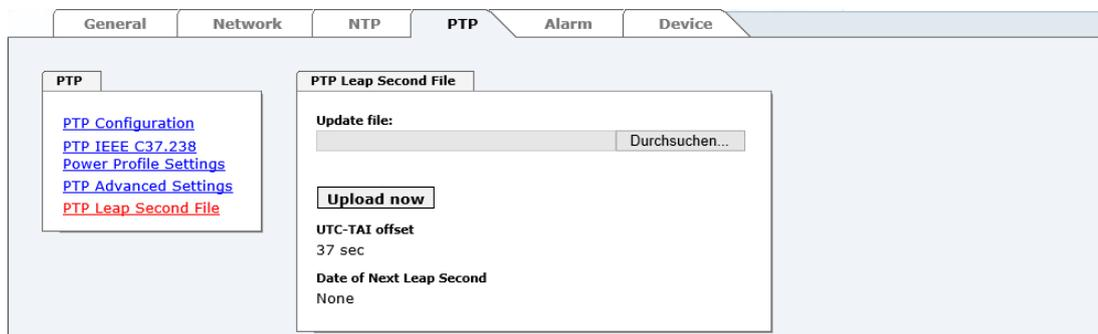
Wenn durch die Synchronisations-Quelle eine Schaltsekunde angekündigt wird, wird die Leap-Second-Datei automatisch aktualisiert.
