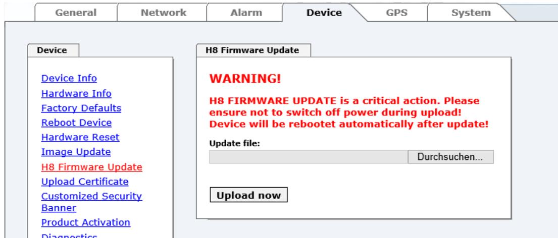
Nach dem H8-Firmwarupdate erfolgt automatisch ein Restart der Karte mit der neuen H8-Firmware.
