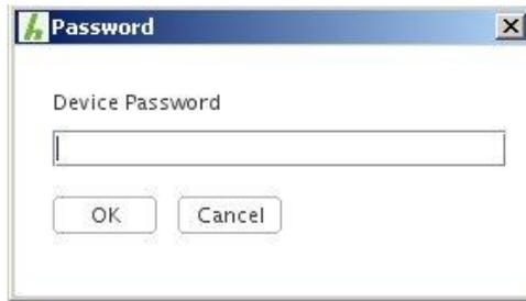
Die LAN-Karten 7052RC werden mit dem gesetzten Device Password **<device>** ab Werk ausgeliefert. Nach der Eingabe wird dieses mit dem Button **OK** bestätigt.
