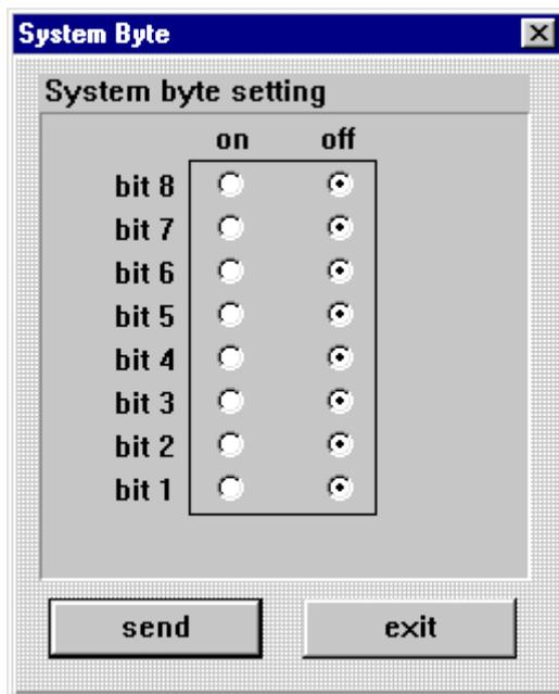
Mit dieser Funktion werden interne Programmfunktionen ein- bzw. ausgeschaltet. Zur Zeit ist nur Bit 1-5 mit einer Funktion belegt. Sie erreichen die Systembyte Einstellungen durch den Menüpunkt "set" und dem Eintrag "System Byte". Es erscheint der "System Byte" Dialog mit den aktuellen Einstellungen in der Uhr.
