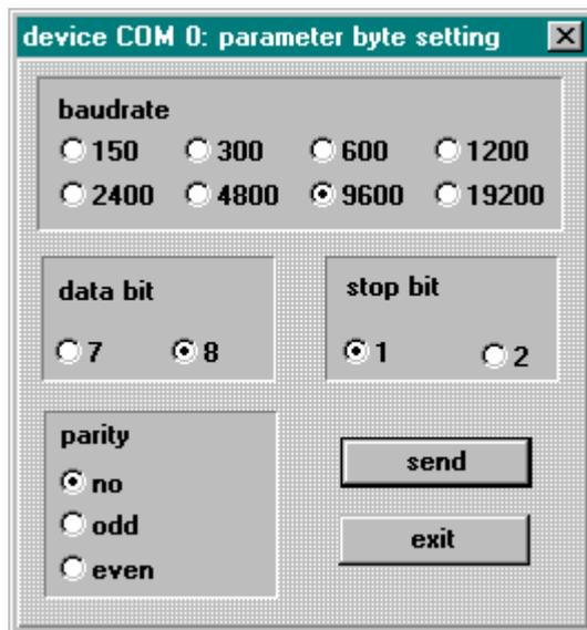
Sie erreichen die Einstellung für Baudrate, Datenbit, Stoppbit und Parity durch Anwahl des Menüs "**communication**" und "**serial parameter**". Es erscheint der Schnittstellenparameter-Dialog für die ausgewählte Schnittstelle.
