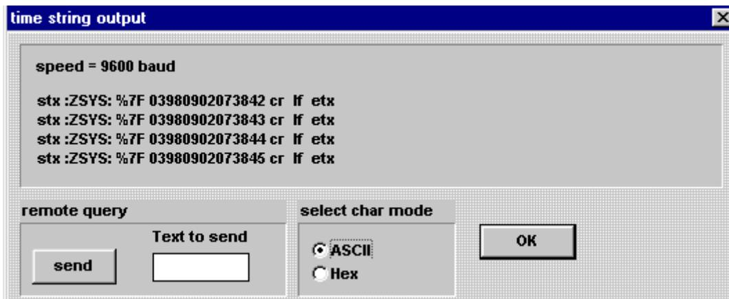
In der Zeile "**speed = 9600 baud**" wird die aktuell eingestellte Baudrate angezeigt.
