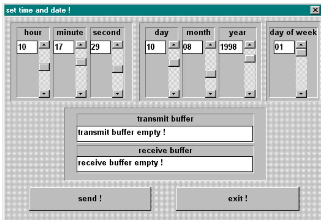
Sie ändern die Zeit durch Verschieben der Scroll Leisten neben den Anzeigefeldern. Nach Einstellung der korrekten Zeit starten Sie die Übertragung zur Uhr mit dem **"send"** Schalter. In dem Statusfeld **"transmit buffer"** erscheint das zur Uhr gesendete Telegramm. Bei erfolgreicher Übertragung wird das gleiche Telegramm im **"receive buffer"** angezeigt.
