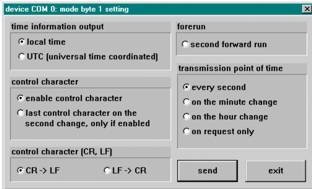
Sie erreichen die Setz-Funktion für das **Modebyte 1** durch Anwahl des Menüs "**communicati-on**" und "**mode byte 1**". Es erscheint der Modebyte 1 Dialog mit den aktuellen Einstellungen für die ausgewählte Schnittstelle. Sie können jetzt den Ausgabemechanismus nach Ihren Vorgaben konfigurieren. Sie starten die Übertragung zur Uhr mit dem "**send**" Schalter. Wenn die Daten angenommen wurden erscheint ein Dialogfenster mit dem Hinweis:
