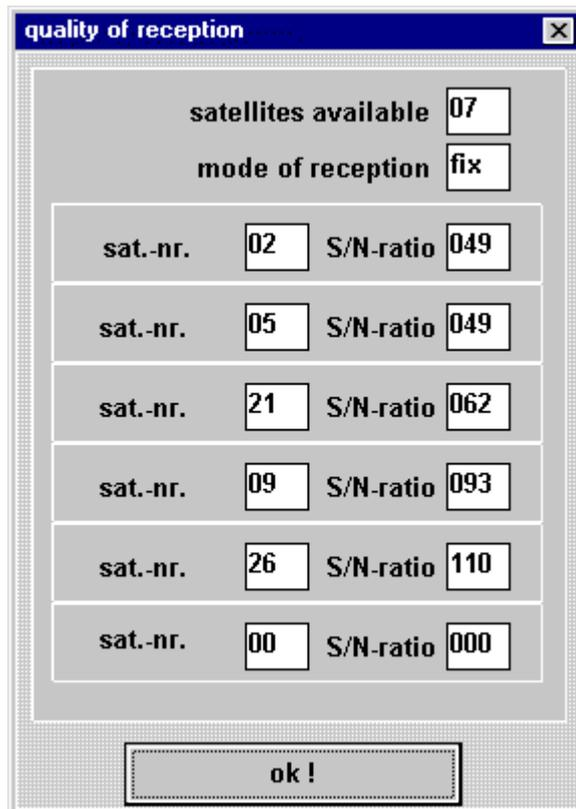
Unter "**satellites available**" erscheint danach die Anzahl der Satelliten, die für die Antennenposition an diesem Standort sichtbar sind. Unter "**mode of reception**" steht die eingestellte Betriebsart.
