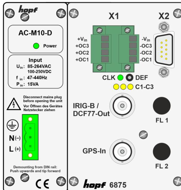
**Beispiel:** Hutschienenmodul 6875AC mit AC-Netzteil AC-M10-D
