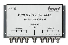
Die Spannungsversorgung erfolgt systemintern über das GPS Antennenkabel von den angeschlossenen *hopf* GPS Empfängern an den jeweiligen Master-Ausgängen. Es wird keine externe Spannungsversorgung zum Betrieb des Gerätes benötigt.
