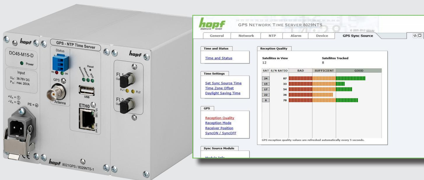
Frontansicht 8029NTS mit 1 standardmäßig integrierten NTP Zeitserver, 1 USB-Port, 2 x Signalausgabe (IRIG-B, DCF77 oder Zyklische Impulse) via Lichtwelle, Spannungsversorgung: 36-76V DC
