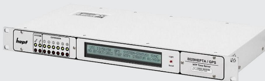
Frontansicht 8029HEPTA DataCenter mit Display und Status-LEDs
