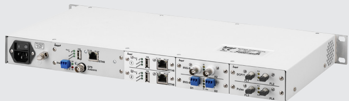
Rückansicht 8029HEPTA Industry mit 3 vollständig voneinander unabhängigen NTP Zeitservern, 2 x IRIG-B analog (BNC-Stecker), 2 x IRIG-B digital (Klemme) sowie 2 x DCF77 Takt und 2 x Zyklische Impulse (jeweils Lichtwelle)
