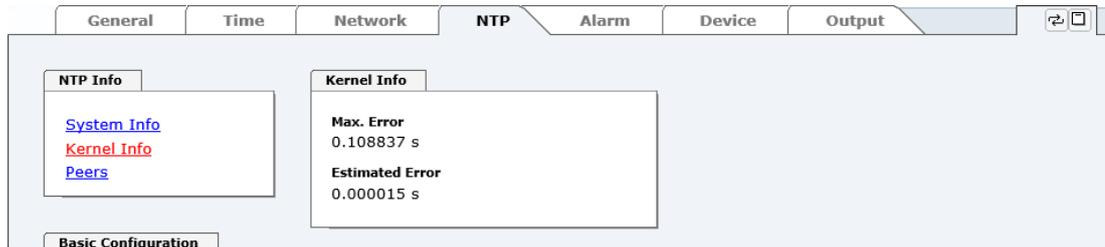
Dieser Screenshot zeigt einen maximalen Fehler der Kernel-Uhr von 108,837 msec (Millisekunden) an, der geschätzte Fehlerwert liegt bei 15 µs (Mikrosekunden).
