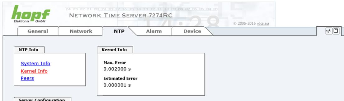
Dieser Screenshot zeigt einen maximalen Fehler der Kernel-Uhr von 2,000 msec (Millisekunden) an, der geschätzte Fehlerwert liegt bei 1µs (Mikrosekunden).
