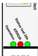
Die Karte 7273(RC) verfügt über 3 Status-LEDs die den grundsätzlichen Funktionszustand der Karte anzeigen.
