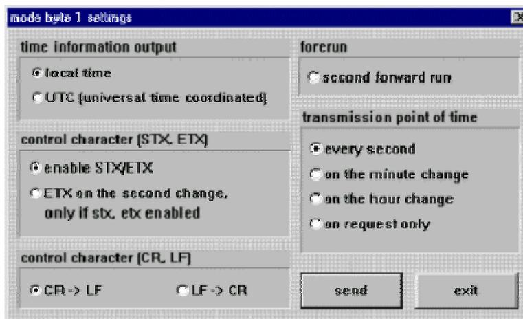
Sie erreichen die Setz-Funktion für das **Modebyte 1** durch Anwahl des Menü "**communication**" und "**mode byte 1**". Es erscheint der Modebyte Dialog mit den aktuellen Einstellungen in der Uhr.
