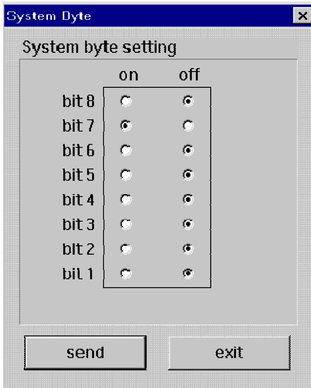
Mit dieser Funktion werden interne Programmfunktionen ein- bzw. ausgeschaltet. Zur Zeit sind nur Bit 8,7 und 1 mit einer Funktion belegt. Sie erreichen die Systembyte Einstellungen durch den Menüpunkt "set" und dem Eintrag "system byte". Es erscheint der "System byte" Dialog mit den aktuellen Einstellungen in der Uhr.
