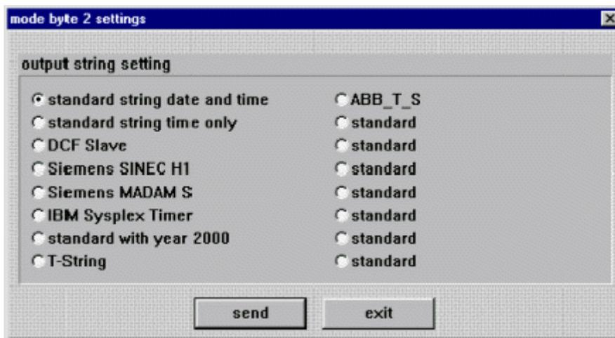
Sie erreichen die Setz-Funktion für das **Modebyte 2** durch Anwahl des Menü "communication" und "mode byte 2". Es erscheint der Modebyte Dialog mit der aktuellen Einstellung der Uhr.
