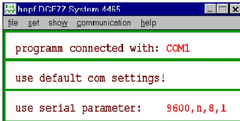
Die Software sucht sich den **ersten** freien COM-Port (1-2) automatisch und zeigt die Verbindung in der Zeile **“programm connected with“** im Hauptfenster der Anwendung an. Hier werden auch die aktuellen Parameter für die serielle Kommunikation sowie die evtl. benutzte Datei für serielle Parameter angezeigt.
