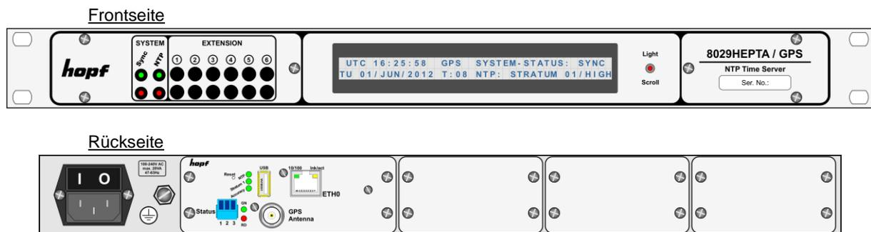
Der Time Server 8029HEPTA/GPS ist in einem 1HE/84TE 19" Baugruppenträger (Slim Line) integriert und zeichnet sich durch seine einfache und übersichtliche Bedienung aus. Einige der praxisorientierten Funktionalitäten sind z.B.:
