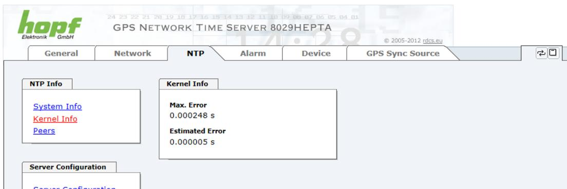
Dieser Screenshot zeigt einen maximalen Fehler der Kernel-Uhr von 0,248 msec (Millisekunden) an, der geschätzte Fehlerwert liegt bei 5 µs (Mikrosekunden).
