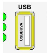
Der USB-Anschluss kann bei bestimmten Problemen, in Absprache mit dem **hopf** Support, für eine Systemwiederherstellung verwendet werden.
