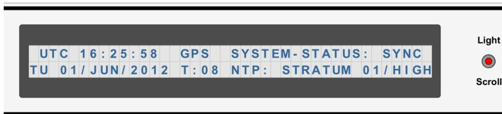
Mit dem Taster Light/Scroll wird die Hintergrundbeleuchtung der LCD Anzeige aktiviert bzw. die Anzeige gesteuert.
