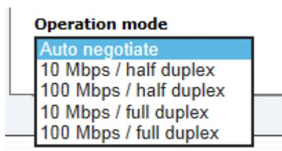
Normalerweise gleicht das Netzwerkgerät den Datenfluss und den Duplex Modus automatisch an das Gerät an, mit dem es verbunden wird (z.B. HUB, SWITCH). Muss das Netzwerkgerät eine bestimmte Geschwindigkeit oder einen bestimmten Duplex Modus haben, so kann dies über die Web Oberfläche konfiguriert werden. Der Wert sollte nur in speziellen Fällen verändert werden. Im Normalfall wird die automatische Einstellung verwendet.
