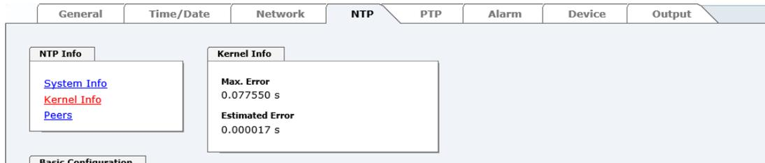
Dieser Screenshot zeigt einen maximalen Fehler der Kernel-Uhr von 77,550 msec (Millisekunden) an, der geschätzte Fehlerwert liegt bei 17 µs (Mikrosekunden).
