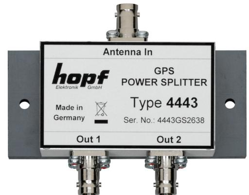
Der Power Splitter ist in einem HF-dichten Gehäuse mit isolierter Bodenplatte aufgebaut. Dadurch kann die Einheit leicht in der Nähe der GPS Empfänger an die Wand geschraubt werden. Die GPS Antenne wird an die BNC-Buchse „Antenna In“ angeschlossen. Auf der gegenüber liegenden Gehäuse-seite befinden sich die beiden Signalausgänge zu den GPS Empfängern.
