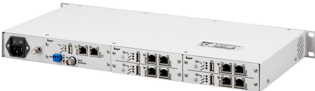
Rückansicht Basissystem 8030HEPTA-02 mit Erweiterung durch 4 zusätzliche, vollständig voneinander unabhängige Netzwerkzeitserver Module 8030NTS-2/M
