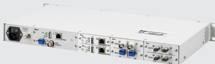
Rückansicht 8029HEPTA Industry mit 3 vollständig voneinander unabhängigen NTP Zeitservern, 2 x IRIG-B analog (BNC-Stecker), 2 x IRIG-B digital (Klemme) sowie 2 x DCF77 Takt und 2 x Zyklische Impulse (jeweils Lichtwelle)
